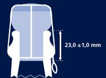
Stellen Sie sicher, dass der Korken bis zu einem Durchmesser von maximal 15,5 mm langsam zusammengepresst wird.
