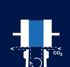
Mit der Vorevakuation des Korkschlosses erhalten Sie die optimale Verschleißdruckreduzierung.
